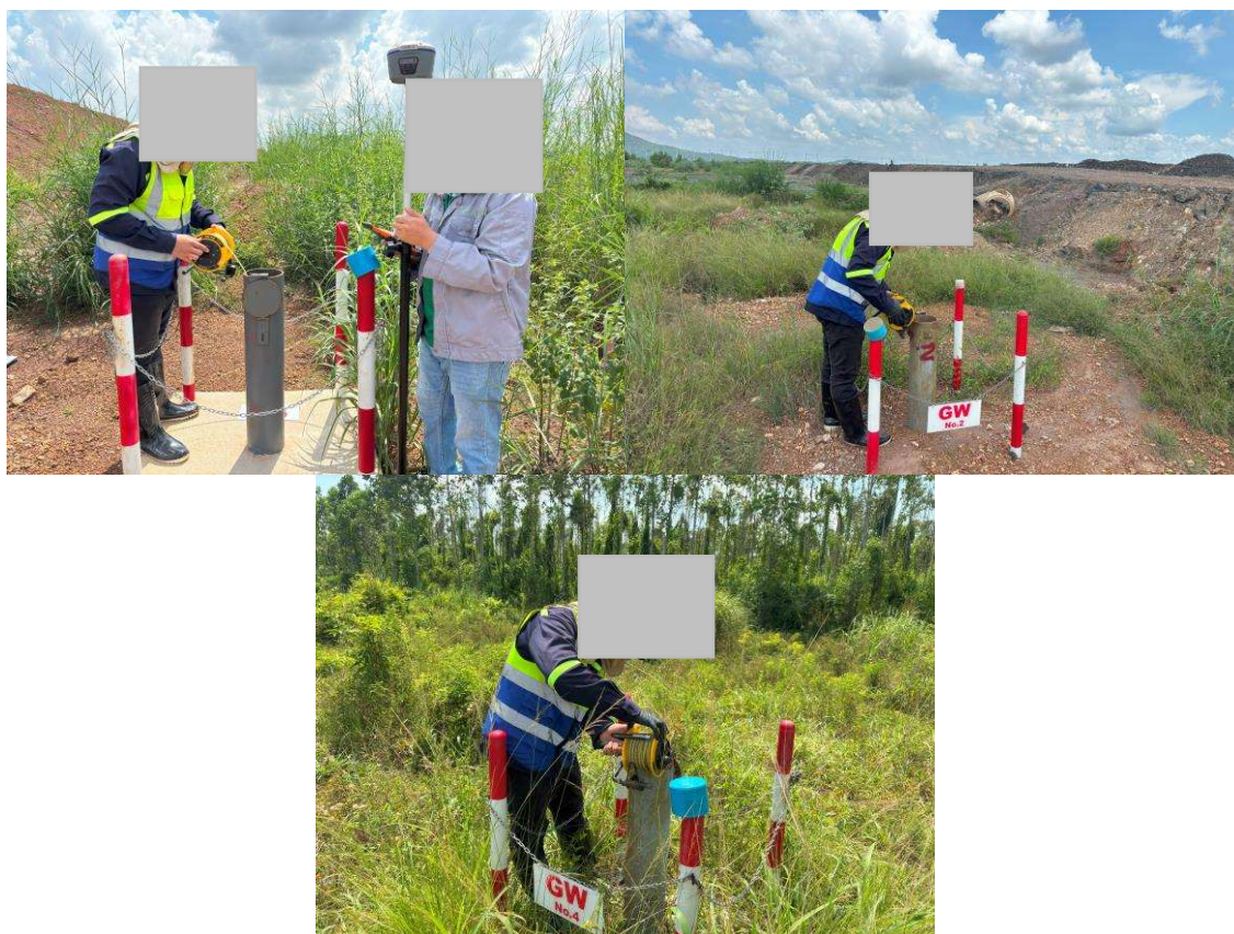
รูปที่ 2 แสดงการวัดระดับน้ำใต้ดินด้วยเครื่องวัดระดับน้ำใต้ดินแบบสายสัญญาณ (Water Level Meter)
